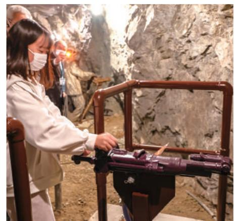
打撃・回転機能を持った手持式の小型空圧さく岩機で、碎石現場での小割や道路工事等の土木工事に使用されたハンドドリル「22D」とレッグドリル「322D」。黒部ダムの建設工事において、最新鋭のさく岩機として活躍した2種類のドリルを、細部までこだわり再現しました。約30キロの重量や、最大毎分1,850回の打撃と200回転の振動、空気の排気音が体験できます。
