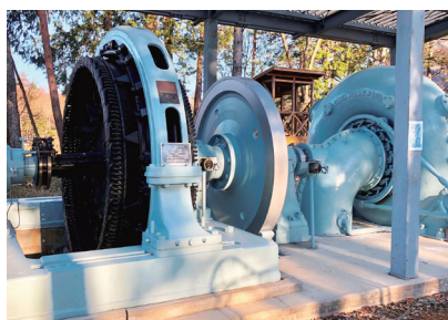
高瀬川第一発電所水車発電機(大正11年～平成2年まで稼働)
